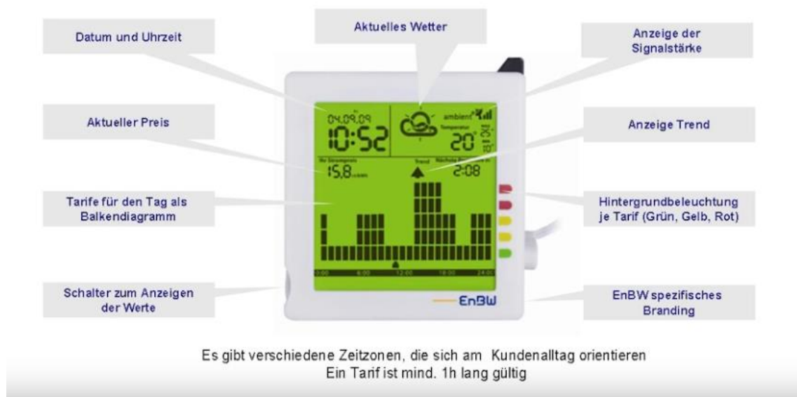
Abbildung 6.2: Beispiel intelligenter Stromzähler mit Visualisierung aus Projekt MeRegio (Modellregion Göppingen)
