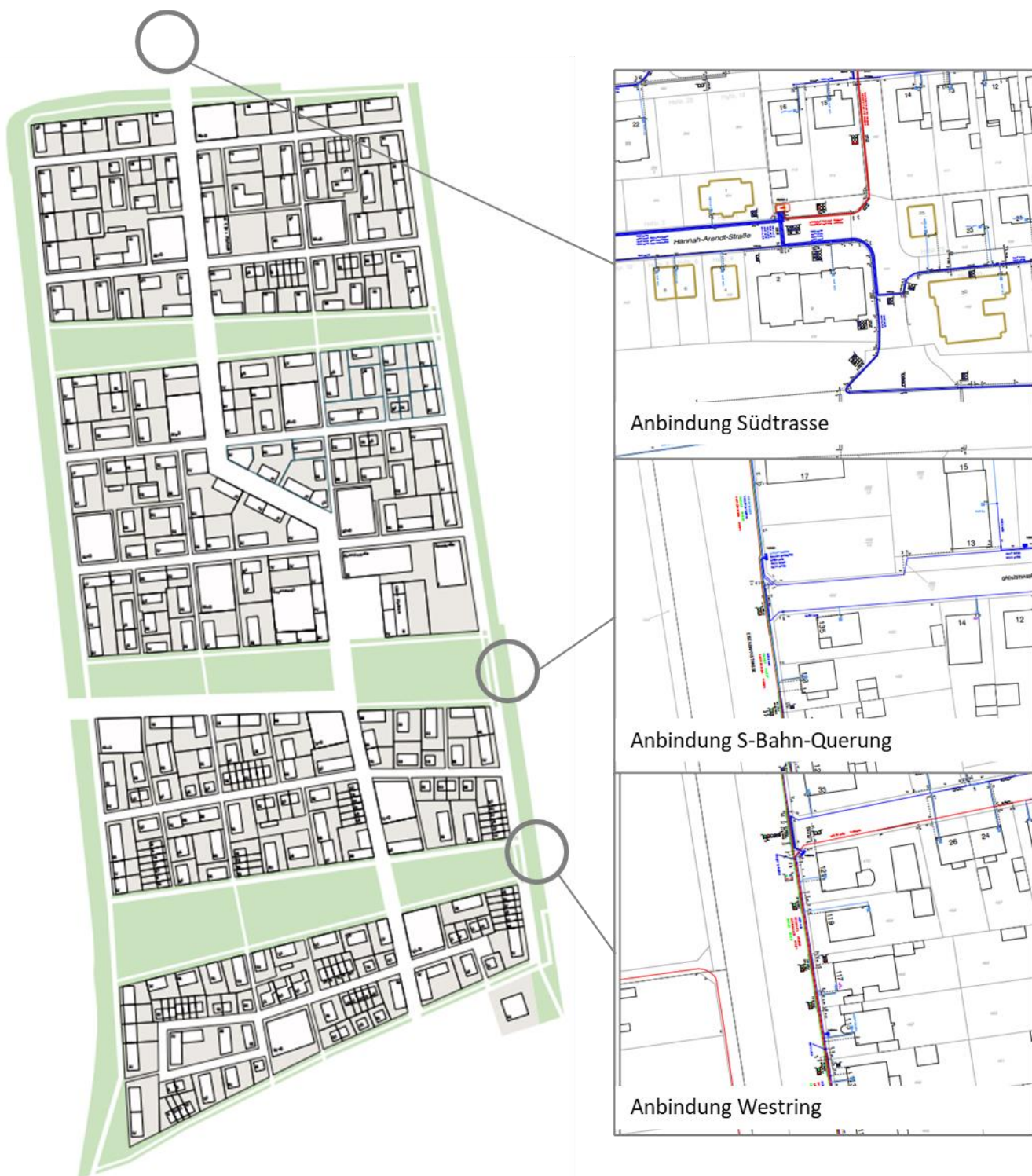
Abbildung 4.5: möglicher Netzverknüpfungspunkt Strom
